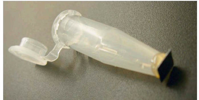
Bild 4: Am Boden gekapptes Reaktionsgefäß mit aufgeklebtem photonischem Chip
